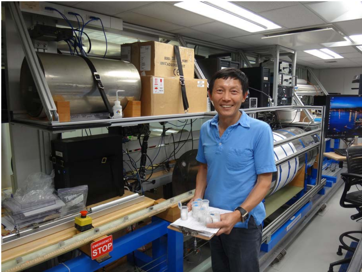
作者正在使用船上的长岩芯超导磁力仪
